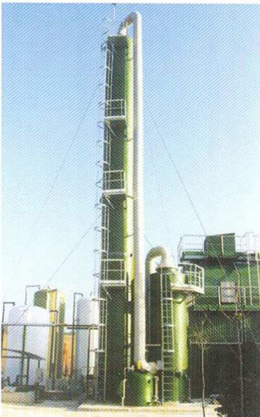
NH 3 stripping on an urban landfill 城市垃圾厂的除NH 3 气提装置
